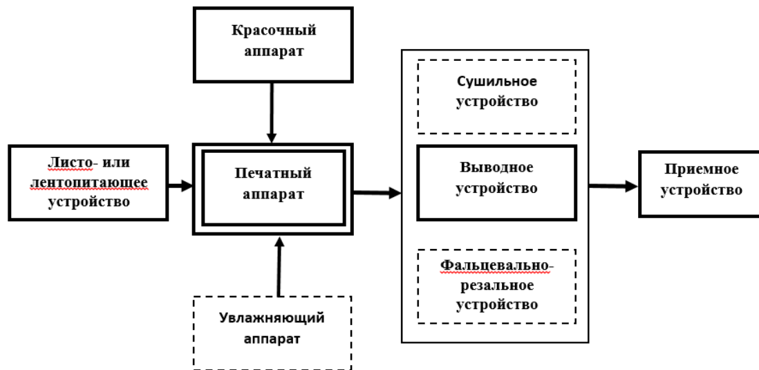
Рис. 1. Структурная схема печатной машины
