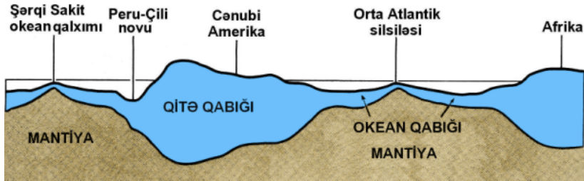
Şəkil 14. Şərqi Sakit okean qabcımından Afrikaya qədərki kəsilişdə okean və qitə qabıqlarının müqayisəli qalınlığı. Okean silsilələri altında qabığın nazikləşməsi və qitələrin dağ silsilələri altında qalınlaşması müşahidə olunur (Şaquli miqyas böyüdülmüşdür: 1 sm=25 km) [36].
